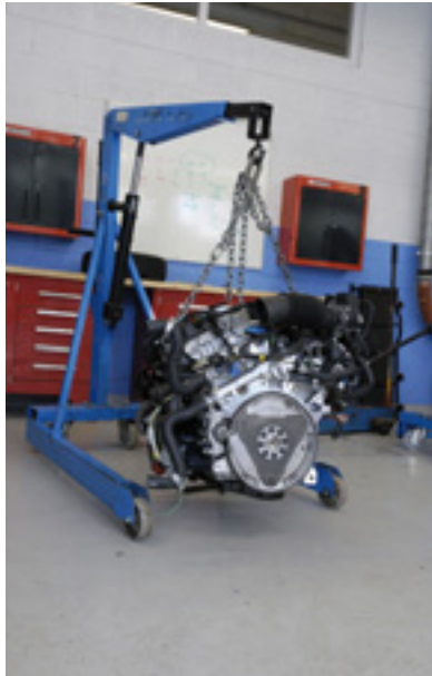
18. Grue d'atelier ou « girafe », aide efficace pour toutes manipulations de pièces lourdes
