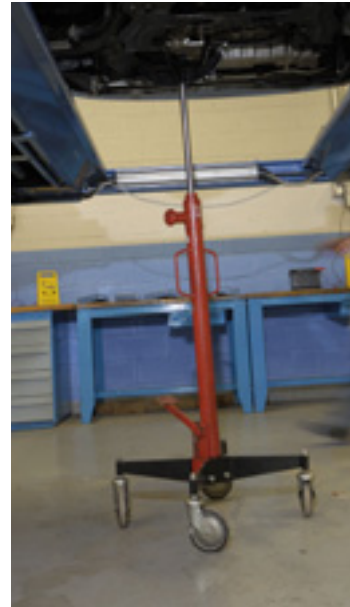
19. Vérin de fosse hydraulique
