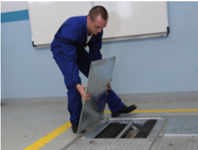
26. Banc d'essais de freinage muni de protecteurs mobiles
