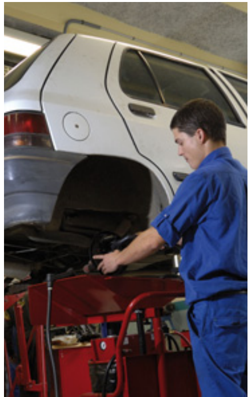
37. Dépoussiérage des garnitures de frein par voie humide
