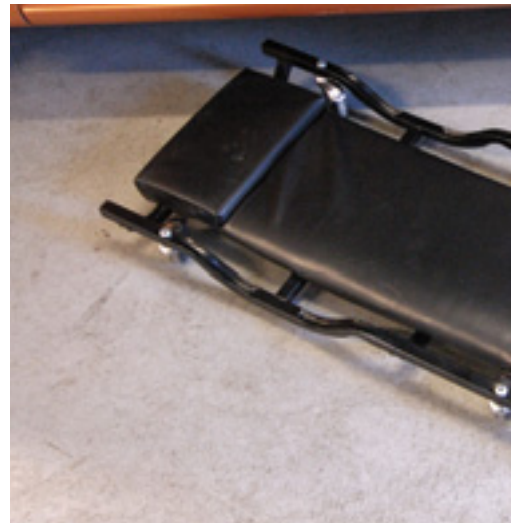
22. Sommier roulant permettant de travailler sous un véhicule
