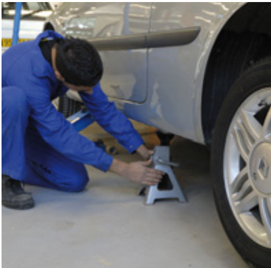
21. Chandellette tripode conçue pour effectuer des calages
