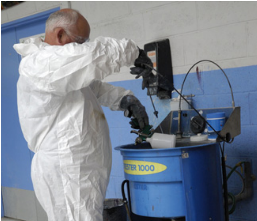
34. Poste de nettoyage des pistolets de pulvérisation de peinture hydrodiluable.
