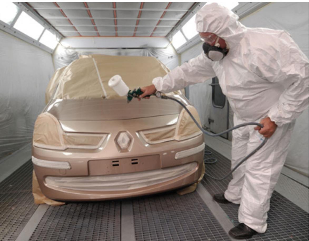
35. Travaux de peinture dans une cabine ventilée
